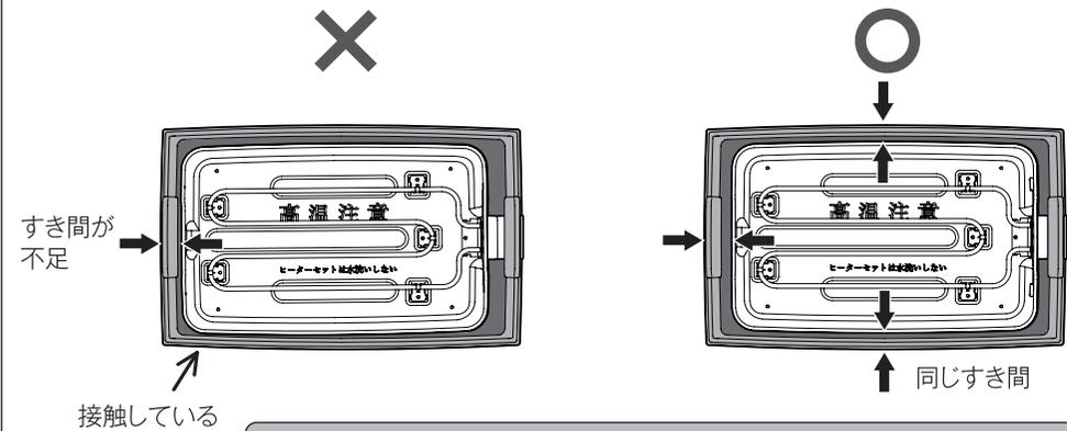
すき間にかたよりがあつたり、接触している場合は正しくセットされていません。ヒーターセットの脚4カ所が確実にセットされていると、ほぼ同じすき間になります。
