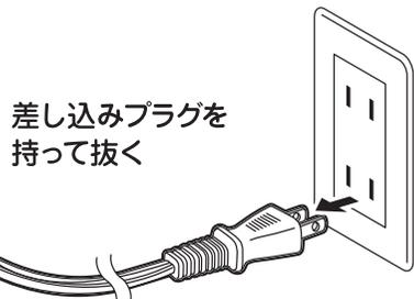
※抜くときは、電源コードを持たずに必ず先端のプラグ部を持って引き抜く。
