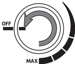
上の図のように、中央の温度調節ダイヤルを矢印の方向に回し「OFF」に合わせる。
