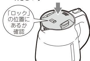
※わかす前に給湯つまみがロックの位置（閉じている）か、確認してください。ふたが確実に閉まっていなかったり、給湯つまみがロックの位置になっていないと、電源が切れなかったり、注ぎ口やふたと本体の隙間から蒸気が出たり、万一倒れたときに熱湯が出てやけどの原因になります。
